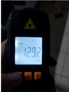
Gambar 14 RPM yang diambil dari tachometer
