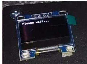
Gambar 11 Tampilan display Oled Shield setelah tapping tag
