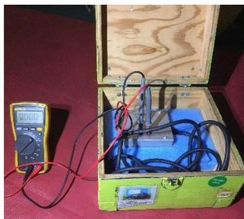
Gambar 8 Pengukuran tegangan igniter squib
