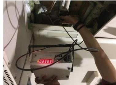
Gambar 9 Proses pengukuran resistansi konduktor
