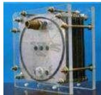
Gambar 2. Elektroliser Tipe Kering
