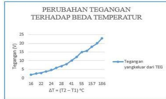
Gambar 6. Grafik Pengujian Perubahan Tegangan Terhadap Beda Temperatur
