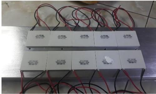
Gambar 5. Rangkaian implementasi 10 modul termoelektrik
