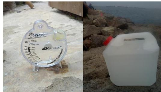
Gambar 4 (a) kadar garam pada hidro meter (b) pengambilan sampel air laut di muara karang.
