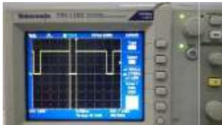
Gambar 6. Foto sinyal PWM dengan kondisi *Throttle* 100%
