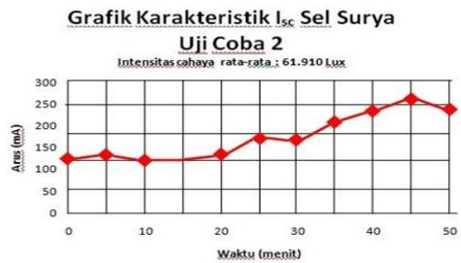
Gambar 9. Grafik hubungan  $I_{sc}$  terhadap waktu dari uji coba 2
