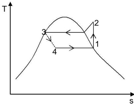
Gambar 2. T-s Diagram Siklus Kompresi Uap Standar [5].
