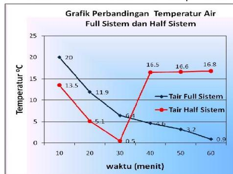
Gambar 11. Perbandingan Temperatur Air Full Sistem Dan Half Sistem Terhadap Waktu
