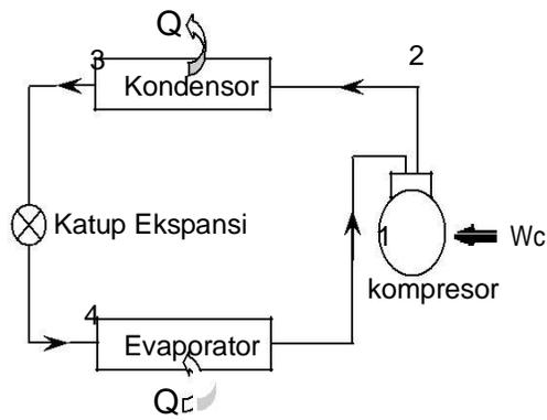
Gambar 1. Skematik Sistem Pendingin Siklus Kompresi Uap Standar [5].
