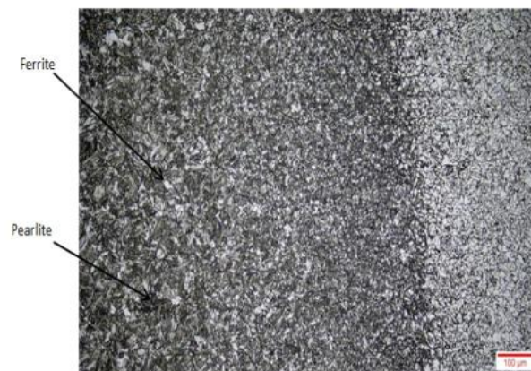
Gambar 5. Struktur mikro daerah pengaruh panas/ HAZ (Perbesaran 200x)
