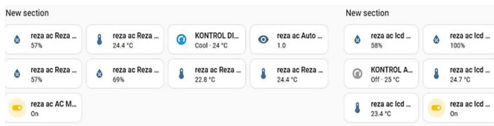
Gambar 7. Pembacaan Suhu berdasarkan DHT-22 (Home Assistant)
