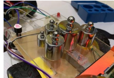
Gambar 8 Pengujian Akurasi sensor loadcell
