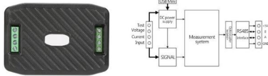
Gambar 4 PZEM 017 dan Blok Diagram[9]
