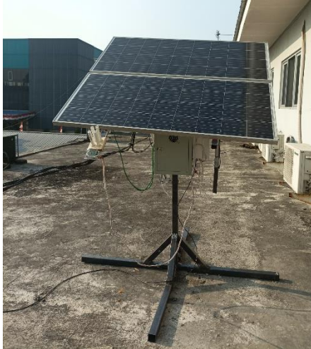
Gambar 6 perancangan solar tracker
