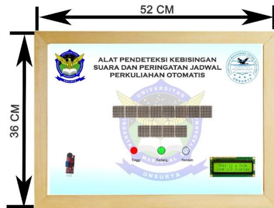
Gambar 9 Desain Alat Pendeteksi Kebisingan Suara
