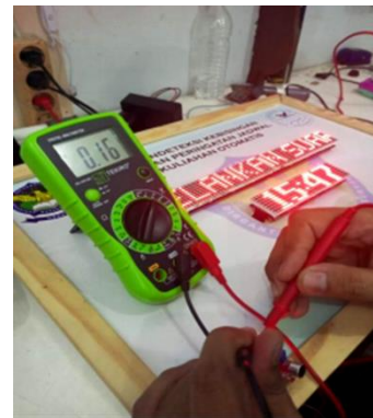
Gambar 11 Pengujian Tegangan Pada Sensor KY-037 Menggunakan Multimeter.
